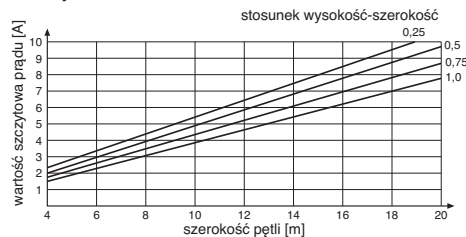
Rys. 7 Wartość szczytowa prądu w pętli indukcyjnej
